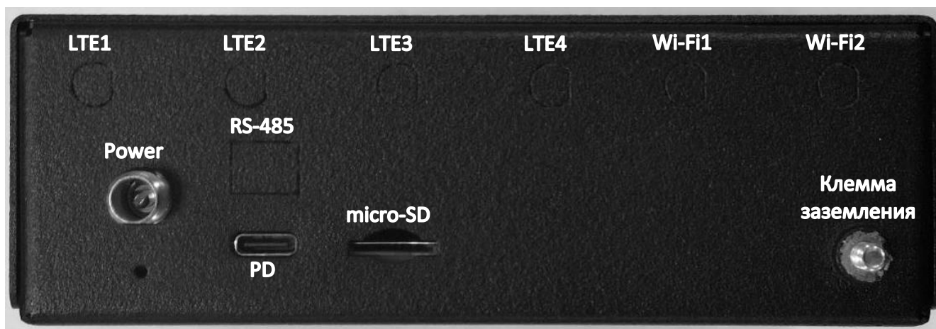
Рисунок 2 – Аппаратная платформа. Вид сзади. Антенны условно не установлены. Надписи на рисунке носят информационный характер и могут не соответствовать маркировке изделия
