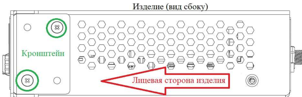
Рисунок 4б – Изделие с установленными кронштейнами для монтажа в стойку
